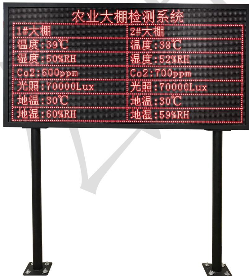
带通信显示 LED 大屏是从云平台获取数据之后并将数据显示在 LED 大屏上的固定设备。大屏可轮屏播放 32 个节点的实时数据，分 4 屏播放，大屏采用 192\*96 阵列，两根立杆间的距离是 1.5m，立杆高 1.5m，屏宽 2m、高 1.04m。字体可设置大小，可远距离直观看到实时数据。
